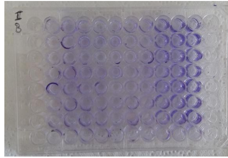
Figura 3. Se pot observa urme de colorant rămase în partea superioară a unor godeuri, care ulterior au fost antrenate în interior în timpul decolorării, ducând la valori false
